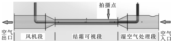
图 3 套管形式换热器结霜可视化通道
